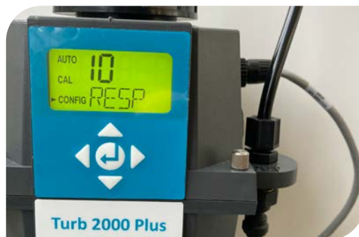
Abbildung 3: Einstellung der Signalmittelung am Trübungsanalyzer
